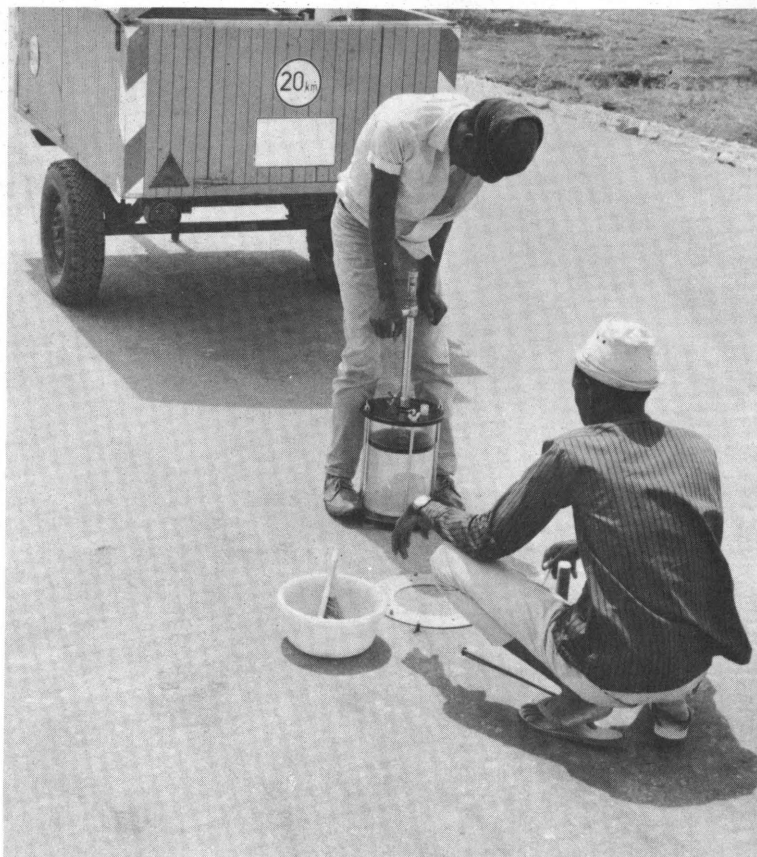
Prélèvement d'un morceau de sol aggloméré : pré-bitumage de la route Afgoi-Baïdo en Somalie.
