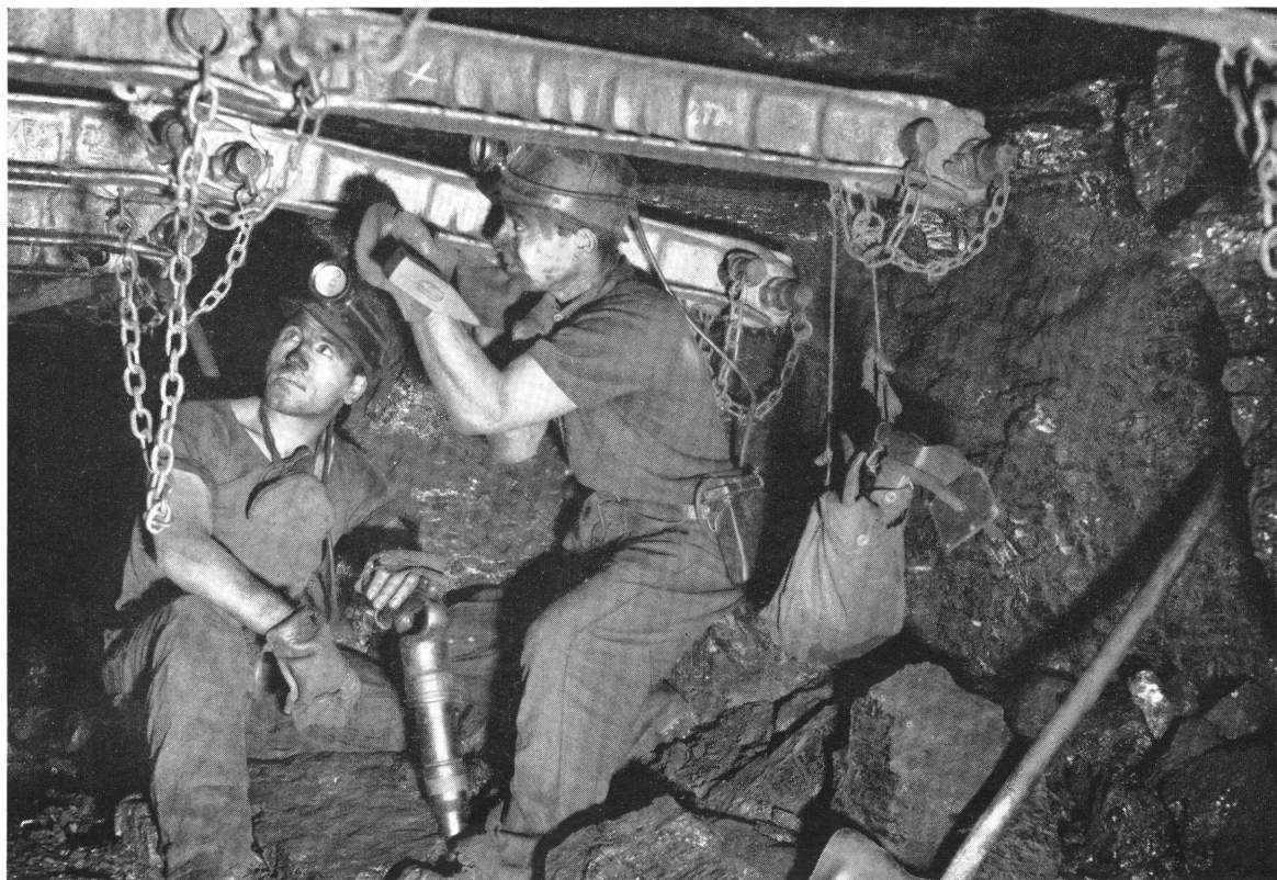
Placement d'une bèle métallique au siège 4 des Charbonnages de Monceau-Fontaine
