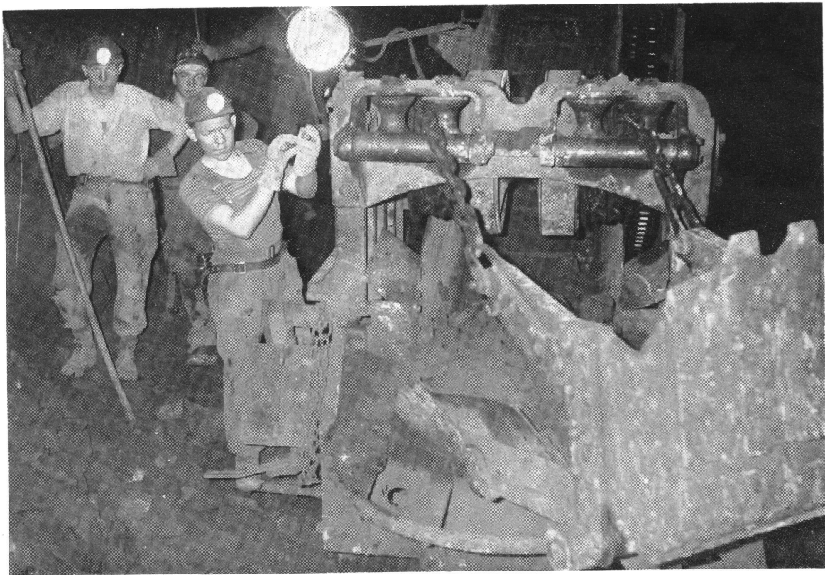
Exercice de chargement du minerai avec chargeuse Conway dans la mine de Moineville
