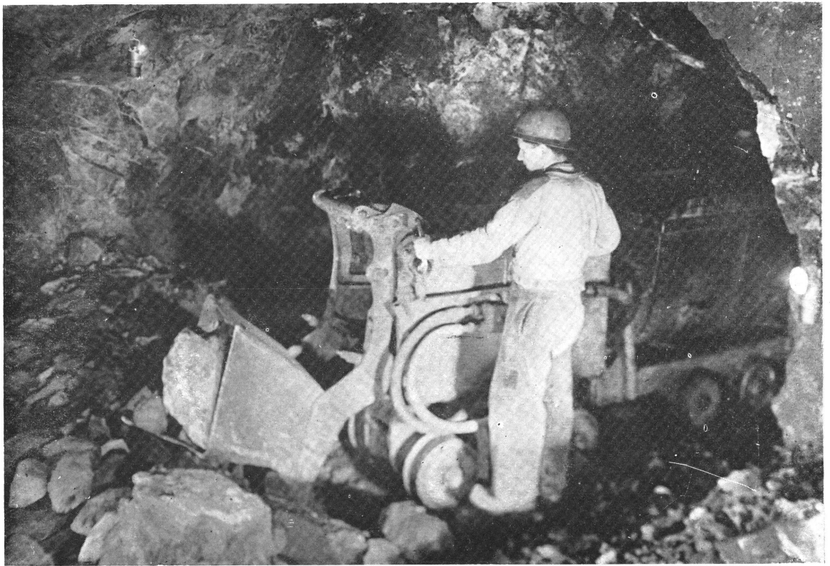
Chargement par pelle mécanique dans une mine de magnétite de Cogne (vallée d'Aoste) (Société « Naz. Cogne »)
