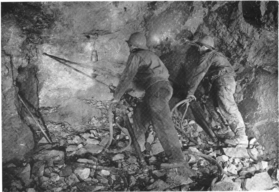
Perforation en veine dans une mine de magnétite de Cogne (vallée d'Aoste) (Société « Naz. Cogne »)
