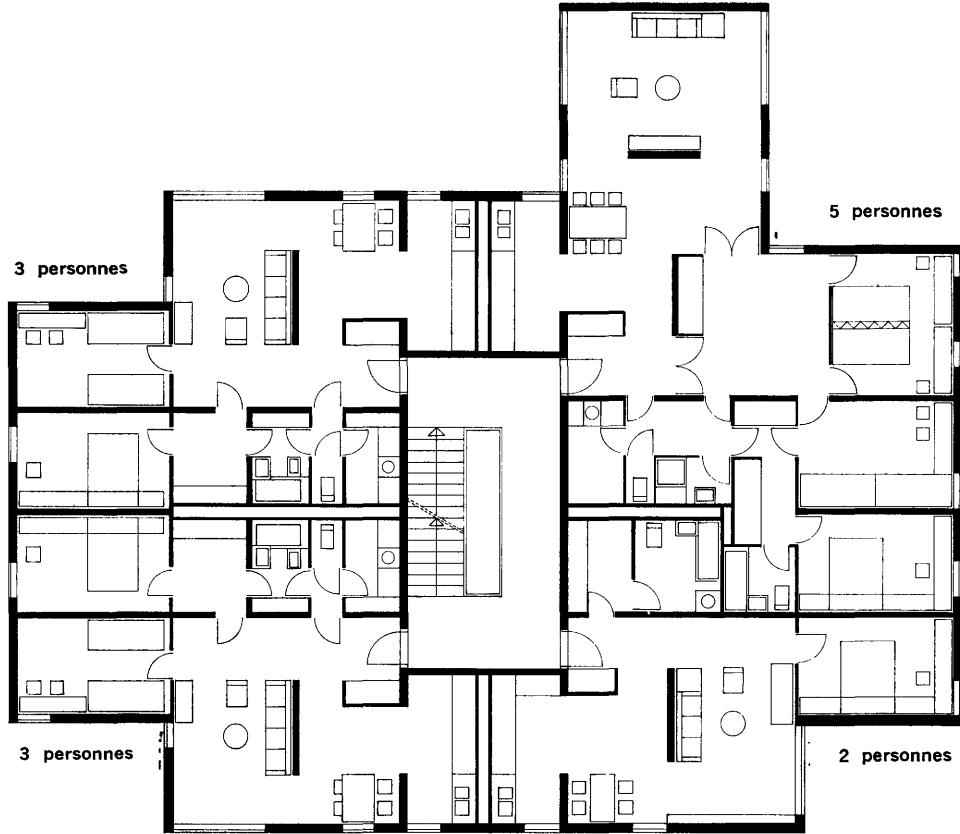
Plan de cellule de l'immeuble collectif à 4 niveaux (dont 3 habitables) Logements pour 2, 3 et 5 personnes
