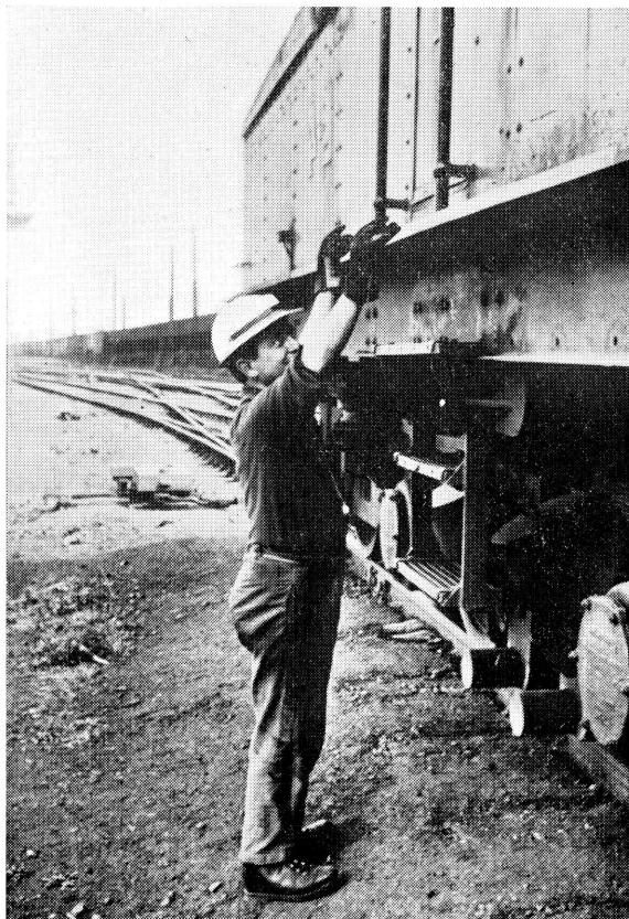
Figure 25. Exemple d'accessibilité difficile sur une locomotive électrique : les marches inférieures sont en retrait et les poignées sont fixées trop haut ; aussi un accrocheur de petite taille ne peut-il utiliser les poignées pour monter dans la cabine (recherche française).
