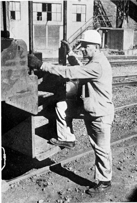
Figure 26. Exemple de bonne accessibilité sur une locomotive Diesel : l'inclinaison de la volée des marches est la même que celle d'un escalier ordinaire et la main-courante peut être tenue sans peine, à la montée comme à la descente, par des sujets de toutes tailles (recherche française).
