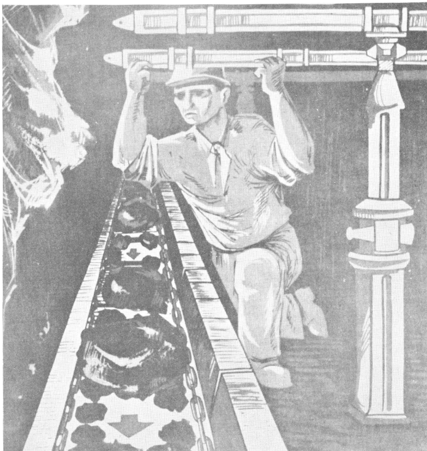
Figure 22 : Activités dans le voisinage immédiat du convoyeur : poser une rallonge au-dessus du convoyeur en regardant dans la direction du transport (Recherche néerlandaise)
