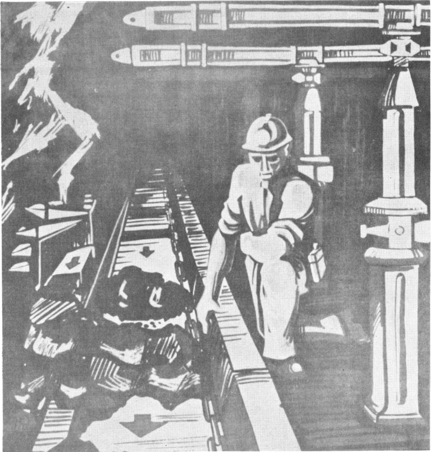
Figure 23 : Position de l'ouvrier près du convoyeur (situation estimée très dangereuse) (Recherche néerlandaise)
