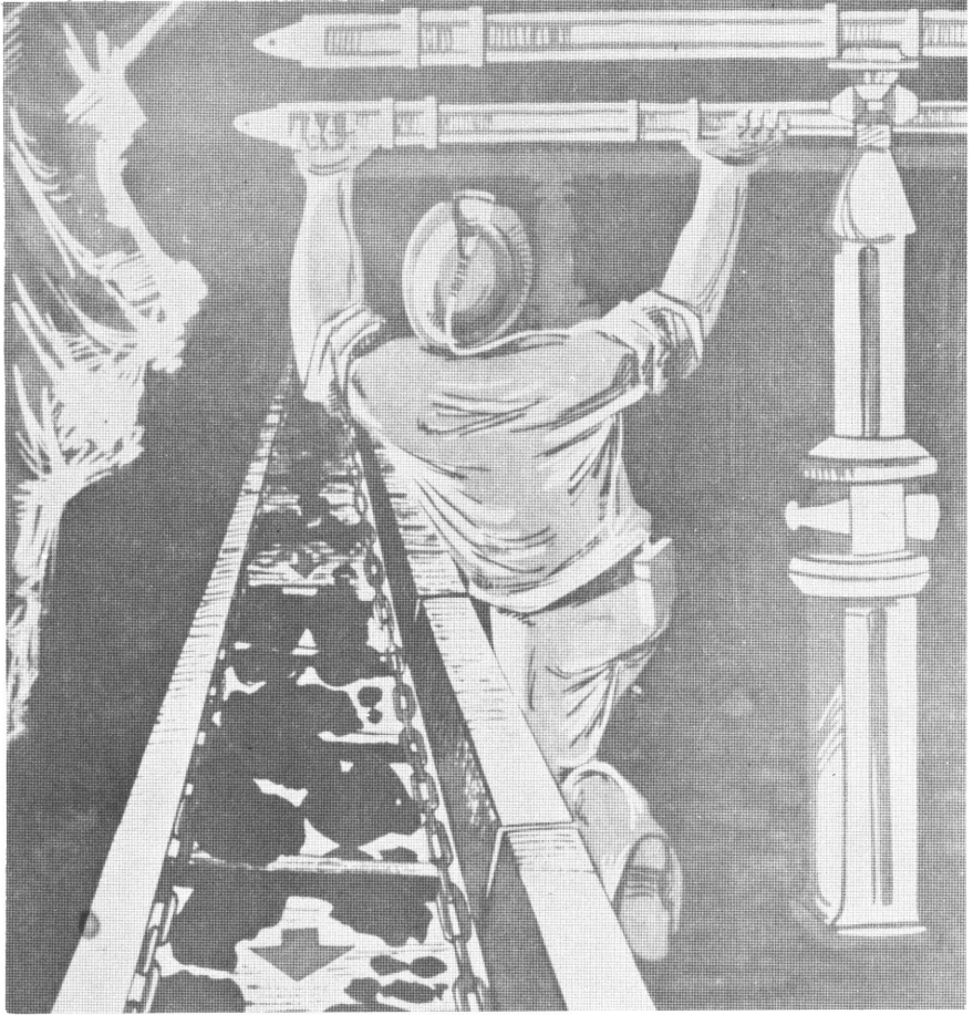
Figure 21 : Activités dans le voisinage immédiat du convoyeur : poser une rallonge au-dessus du convoyeur en regardant dans la direction opposée à celle du transport (Recherche néerlandaise)
