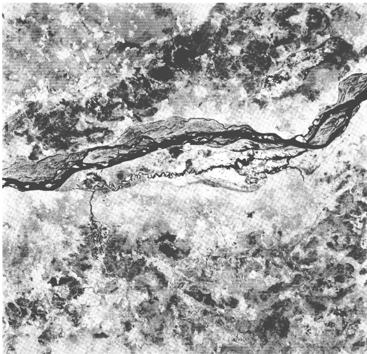
Figure 20: Détail d'une image LANDSAT représentant les sites rizicoles de FAMANA, TAMANI et FARAKO au MALI - Résultat de classement des points en fonction de leur radiance dans le proche infra-rouge ( 0.8 - 1.1 \mu\text{m} ) - Scène du 28 Novembre 1975
