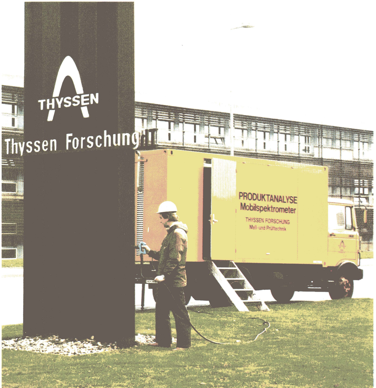
Figure 71: Spectromètre mobile pour l'analyse de contrôle de demi-produits et de produits finis
