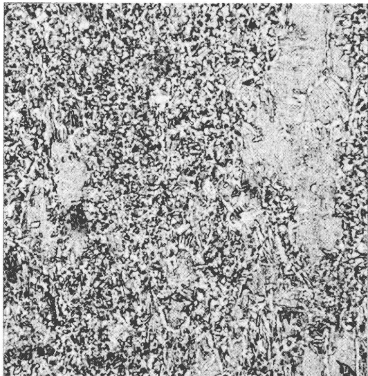
Coulée 1 100:1 Température de laminage : 950 °C
