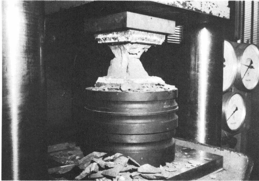
**Abb. 56** Typisches Bruchbild eines Probewürfels
