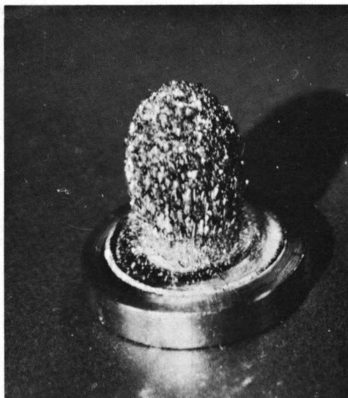
Figure 3.9.VI. Appareillage pour la condensation de l'américium en forme de barre.
