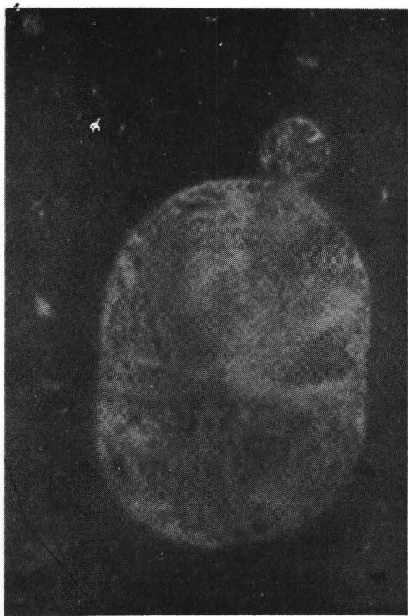
Figure 9 : Mélange résine Escorez 3102 + 10 % de résine novolaque, après chauffage à 430°C. G = 1700 x
