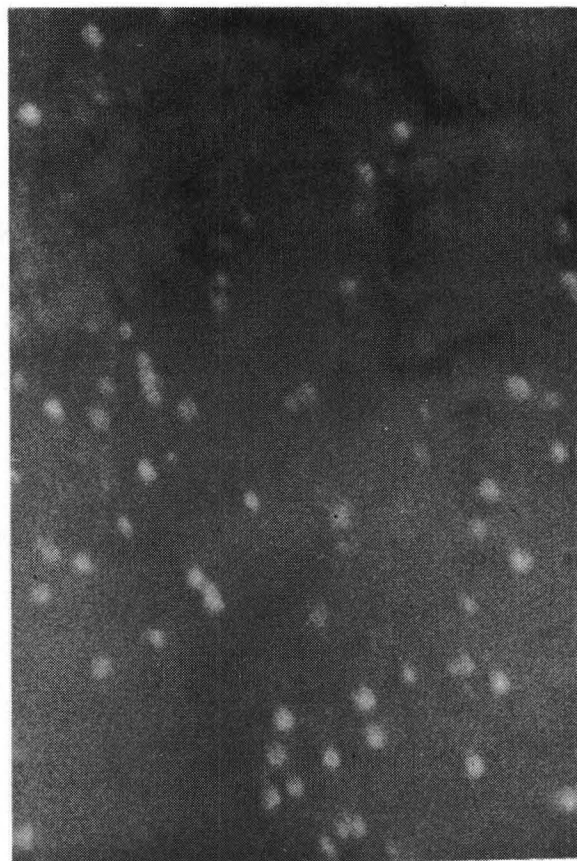
Figure 7 : Mélange résine Escorez 3102 + 10 % de bisphénol F, après chauffage à 430°C. G = 1700 x
