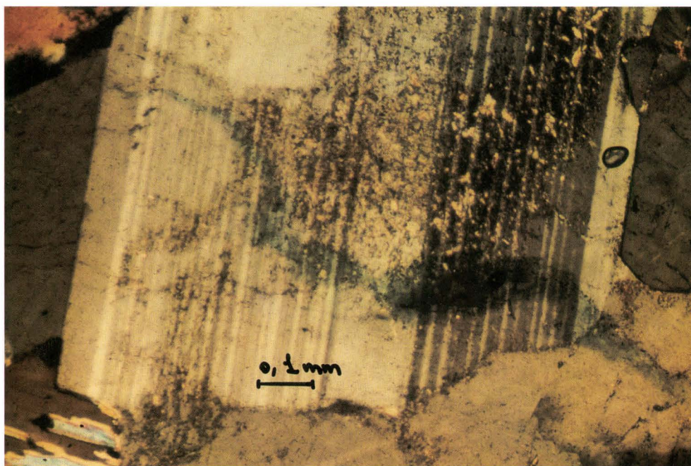
Figure 29 - Fissuration intragranulaire dans un plagioclase (380,50 m)
