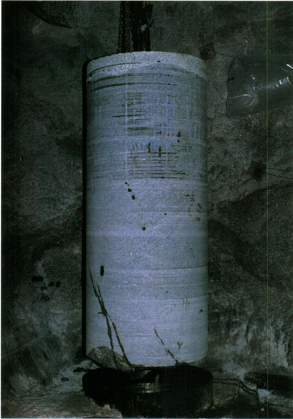
Figure 114 - Carotte FGD2 \phi 1000 et virole en tête de forage
