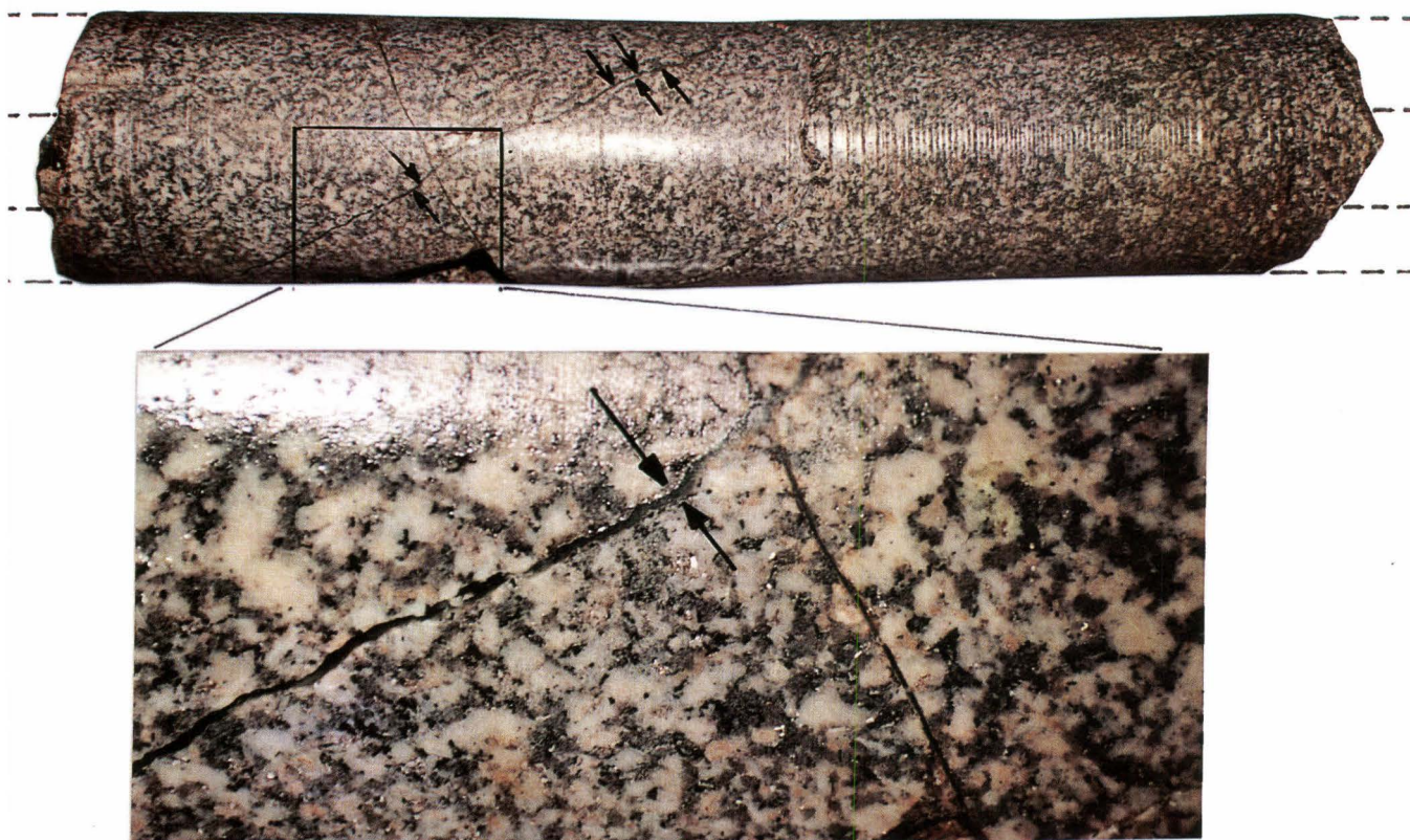
Figure 130 - Surcarotte du forage F5 de 250 mm de diamètre. Elle montre une bonne pénétration de la résine le long des plans
