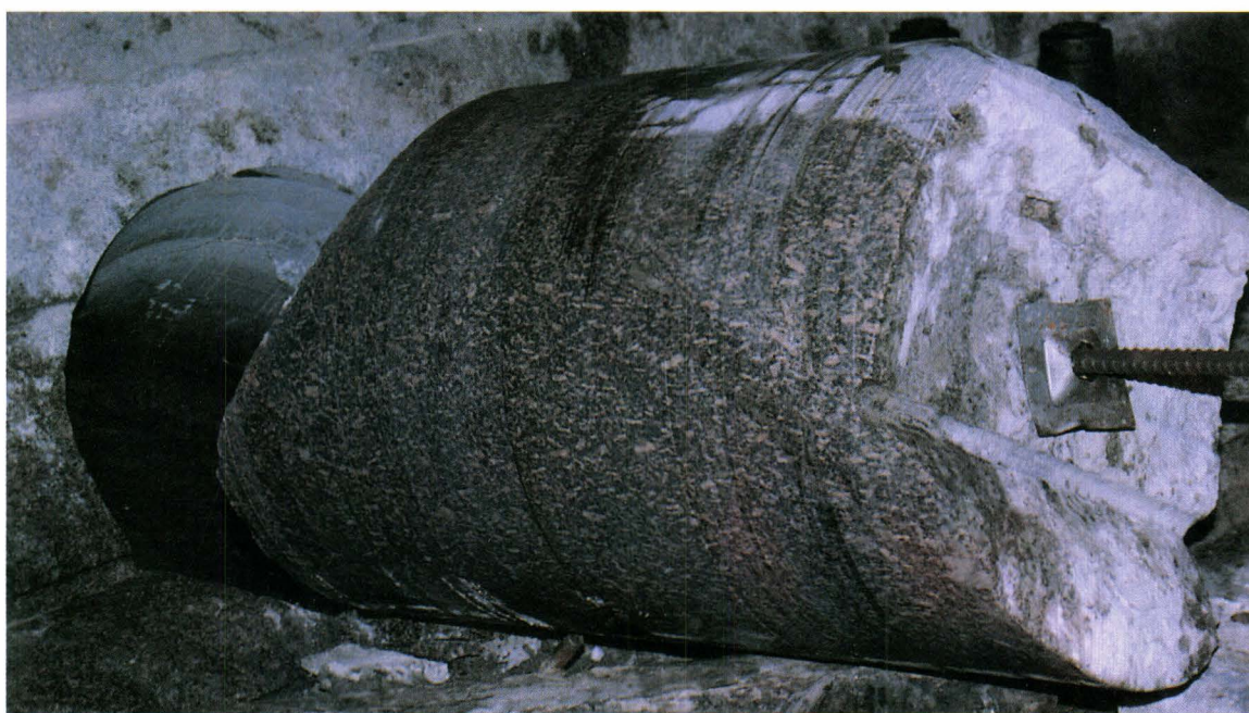
Figure 115 - Extraction de la carotte inclinée FGD3 \phi 750
