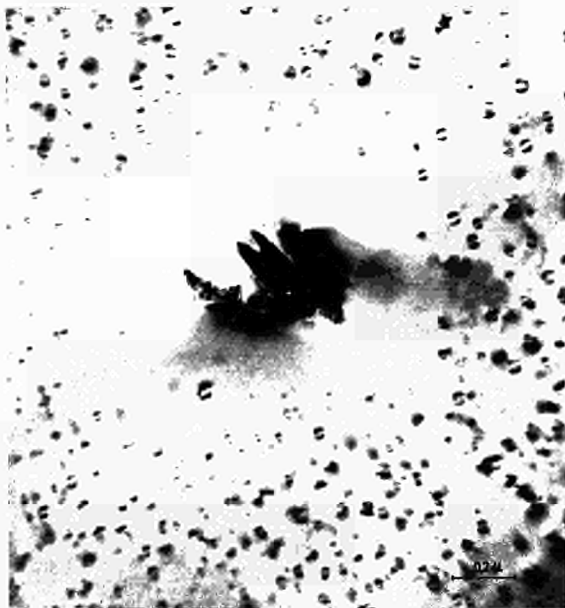
Bild 2. Die Umgebung der Ausscheidung einer zweiten Phase ist frei von Versetzungsringen, da die Leerstellen für den Platzbedarf der wachsenden Ausscheidung verbraucht worden sind.
