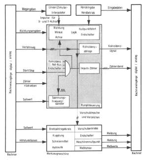
Bild 5: Rumpfsteuerung für eine Drehmaschine
