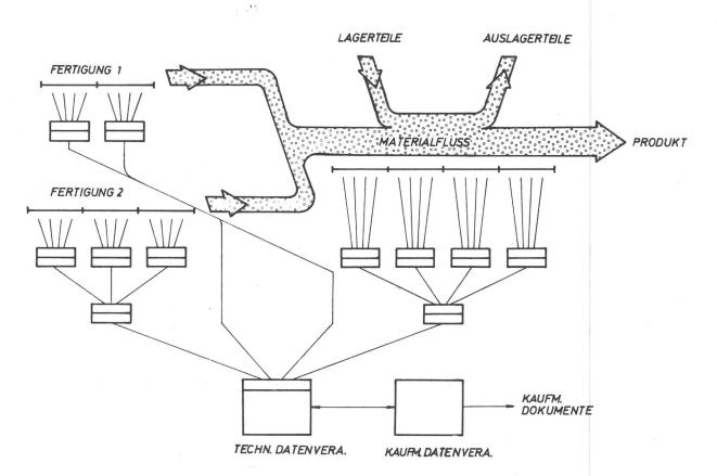
Bild 3 Blockschema für die Anwendung von Rechnersystemen im Bereich der Materialflußverfolgung
