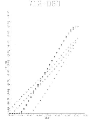
Fig. 2 Die halblogarithmische Darstellung des Basisstroms I<sub>B</sub> und des Kollektørstroms I<sub>C</sub> über der Basis-Emitterspannung bei verschiedenen Bestrahlungszuständen. Die Stromachse ist mit den Zenerpotenzen des Stroms in A beschriftet, die Spannungsachse in Einheiten V.
