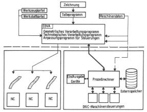
Bild 1: Prinzipieller Aufbau der NC-Fertigung und der DNC-Fertigung
