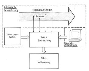
Bild 7: Datenerfassung innerhalb eines Fertigungssystems
