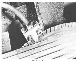
Bild 6 Digitaler Geber für Drehzahlmessung
