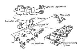
Bild 9: Konfiguration eines integrierten Informationsverarbeitungssystems in der Fertigung (SIEMENS)
