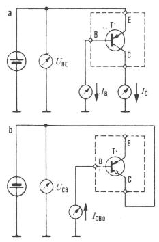
Fig. l a Prinzipschaltung zur Messung des Basisstroms  $\mathbf{I}_{\mathrm{B}}$  und des Kollektorstroms  $\mathbf{I}_{\mathrm{C}}$  in Abhängigkeit von der Basis-Emitterspannung  $\mathbf{U}_{\mathrm{BE}}$  bei verschiedenen Temperaturen T.
