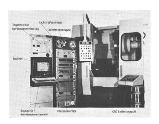
Bild 8: CNC-Steuerung (WZL, TH Aachen)
