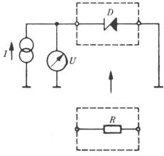
Fig. 3 Prinzipschaltung zur Messung der Zenerspannung U und der Spannung am Widerstand in Abhängigkeit des Stromes I bei verschiedenen Temperaturen T.
