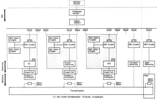
Bild 10: DNC-Fertigungssystem mit verschiedenartigen Steuereinheiten: NC, Rumpfsteuerung, CNC, Transportsteuerung, Lagersteuerung
