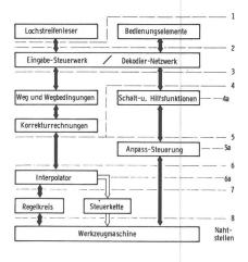
Bild 3: Funktionsgruppen und Nahtstellen zur Rechnerkopplung bei einer NC-Steuereinheit
