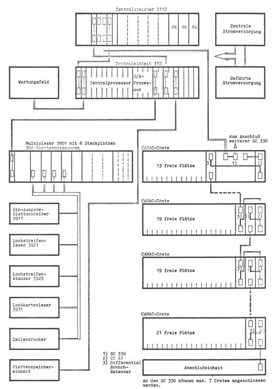
Bild l: Pr-Anlage der FHS Dommund mit Standardperipherie und dezentraler CAMAC-Prozeß-einheit.
