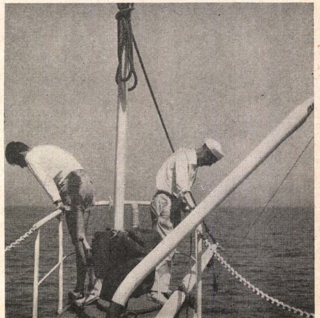
Récupération d'un thermomètre de profondeur. Cet instrument indique simultanément la température et la pression de l'eau.
